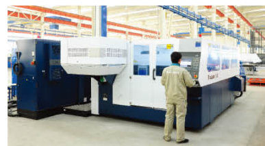
Немецкое оборудование лазерной резки Trumatic L 3030
