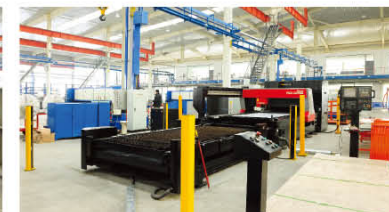
Японское оборудование лазерной резки AMADA FO-3015
